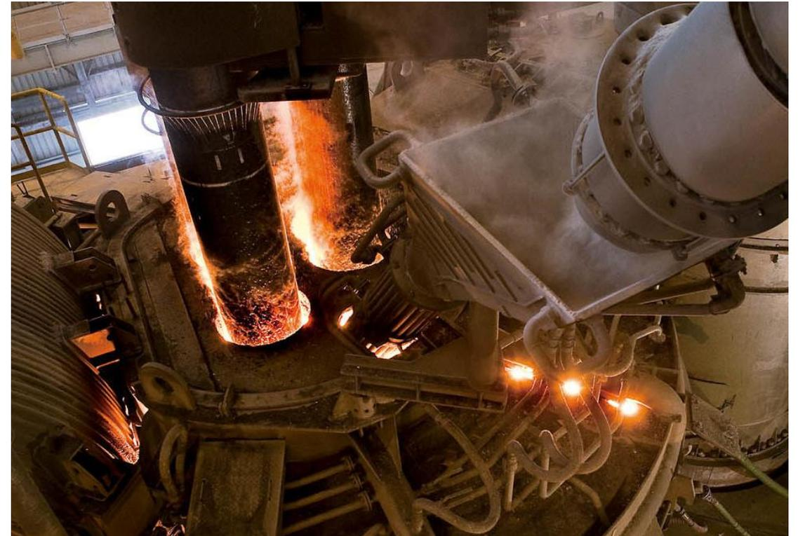
Beispiel einer DRI-Förderung durch einen Deckeltrichter im Betrieb
