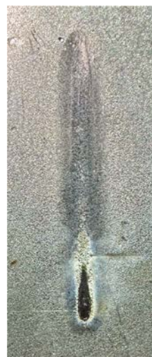
Bild A.2: Schweißgeschwindigkeit zu hoch
