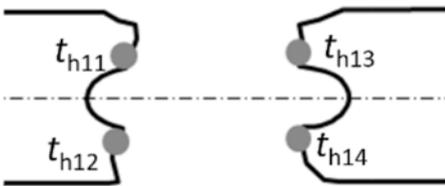
**Bild 9.5.3.** Skizze der Draufsicht (links) und Frontansicht der Bruchflächen beider Prüfstückhälften (rechts). Stellen (Beispiele) zur Messung der Dicken  $t_{h11}$ ,  $t_{h12}$ ,  $t_{h13}$  und  $t_{h14}$  am Prüfstück mit Loch nach der Prüfung
